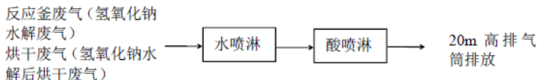
图 3-14 2#废气处理设施处理工艺流程
